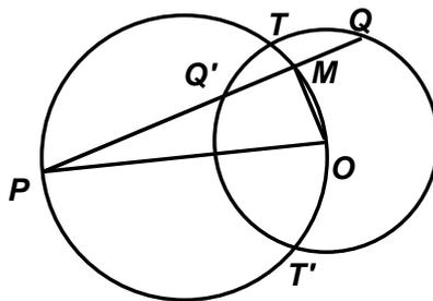
**Figura 4:** Determinação das retas tangentes ao círculo passando pelo ponto P.
